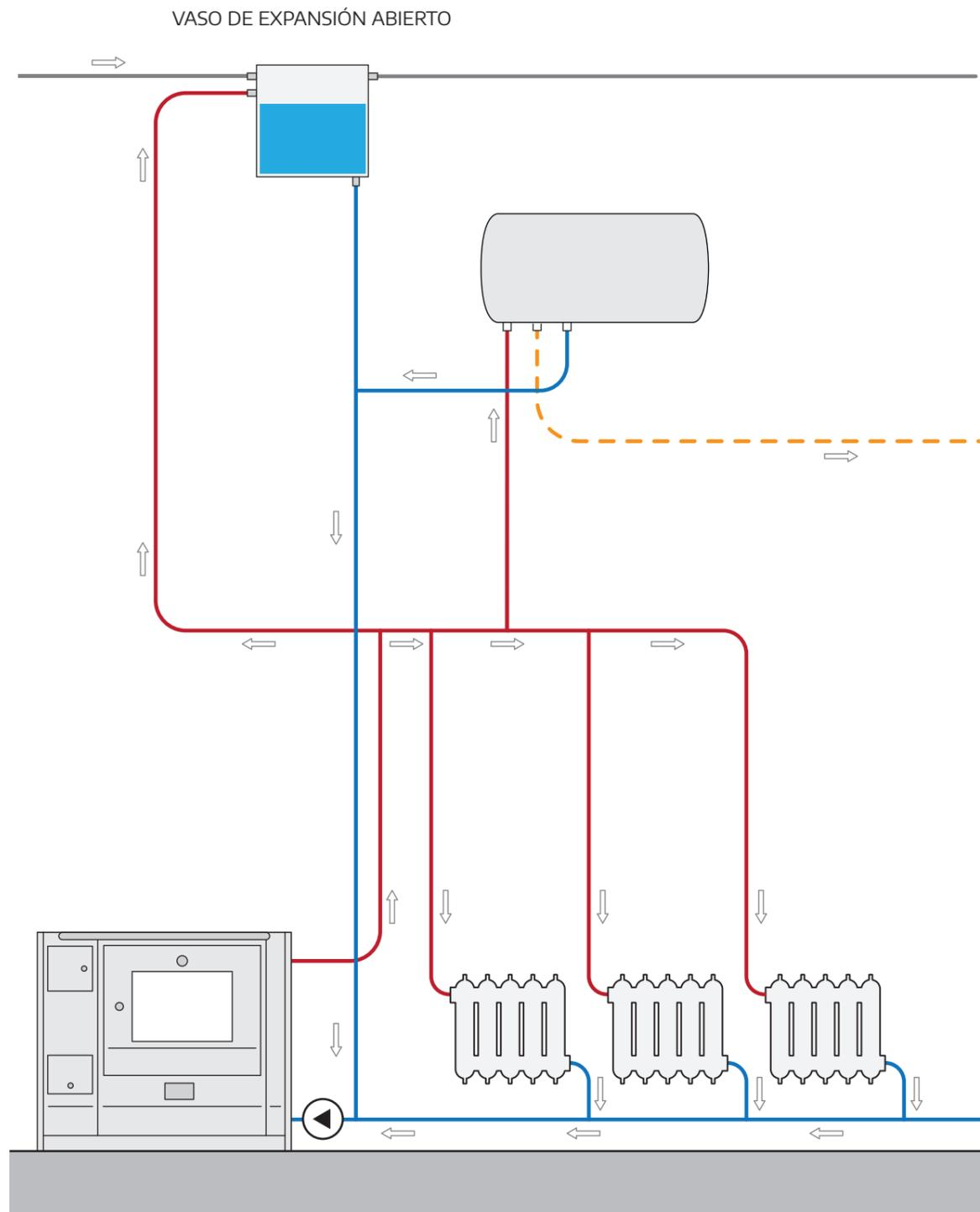
**ATENCIÓN:** IMIGAS garantiza la estanqueidad e integridad de la paila calefactora solo en instalaciones con vaso de expansión abierto.
